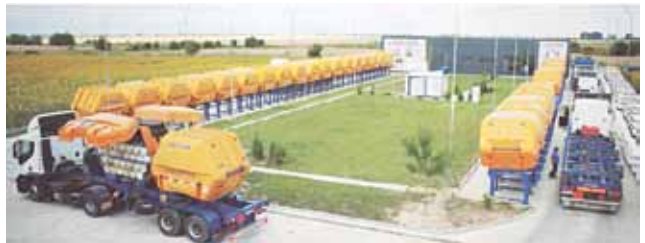
En la estación madre los contenedores MAT son cargados con GNC desde el compresor para su posterior distribución.
