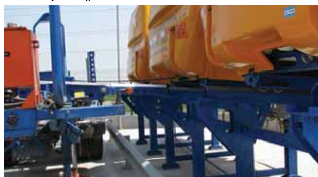
En la estación madre, los MAT cargados con GNC son traspasados desde las plataformas PAC hacia los trailers VST para su transporte.
