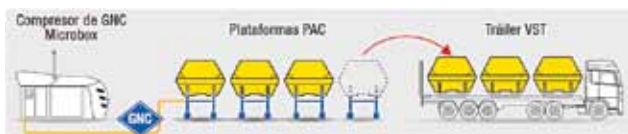
Funcionamiento de la estación madre.
