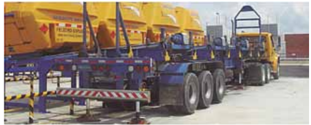
Tráiler VST preparado para la carga de MATs.
