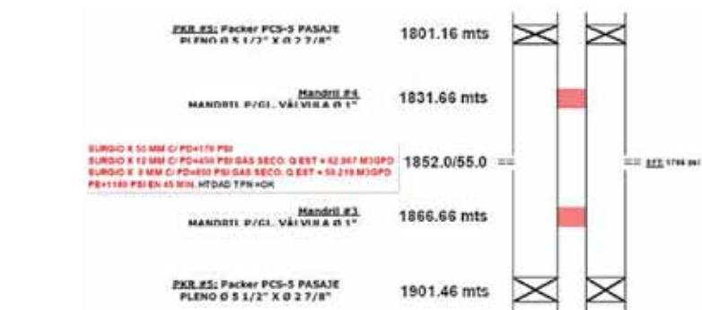
Figura 13. Pozo-3-Zona 3 con dos mandriles.
