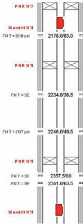
Figura 18. Pozo-4-Zonas ciegas entre mandriles productores.
