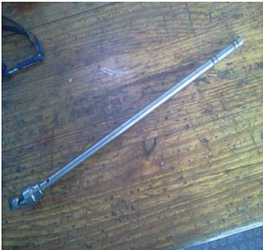
Figura 22. Llegada del Prong en superficie luego de pescar con equipo SL.
