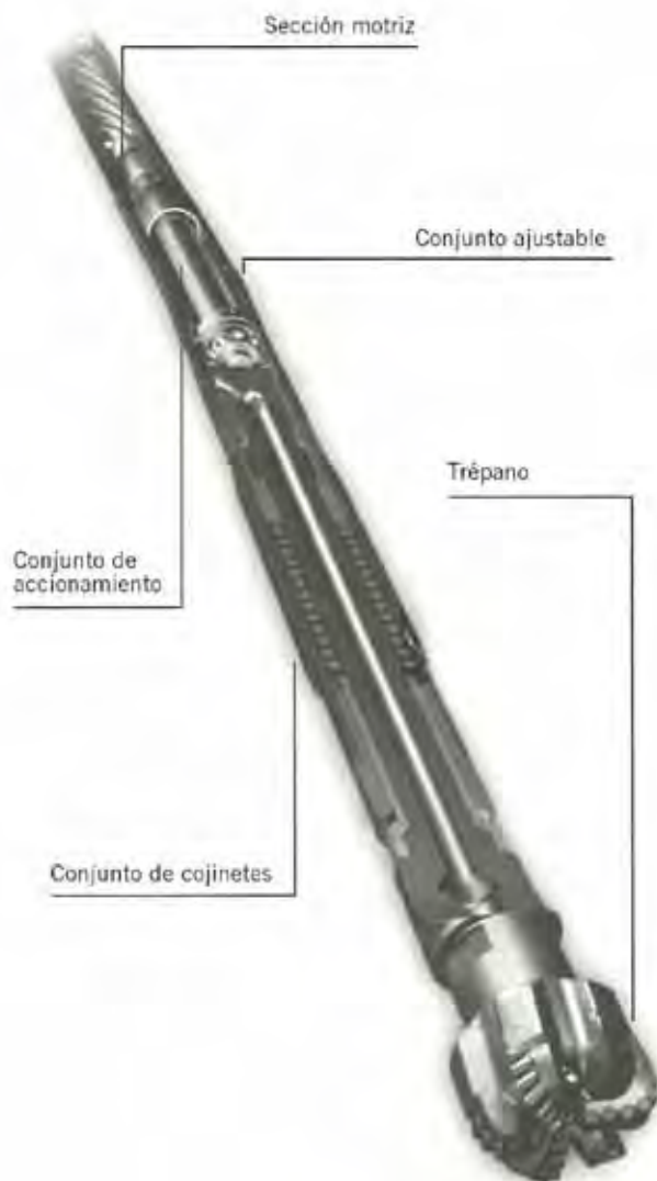
Figura 9b. Motor de fondo tipo Moineau.
