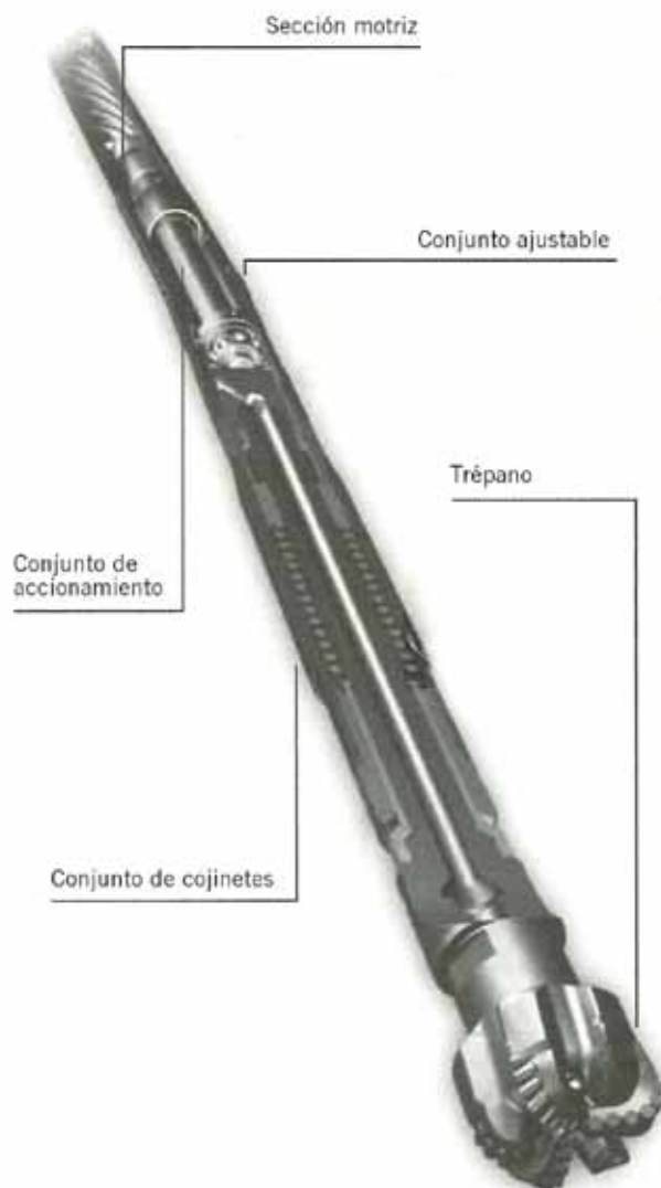
Figura 9b. Motor de fondo tipo Moineau.
