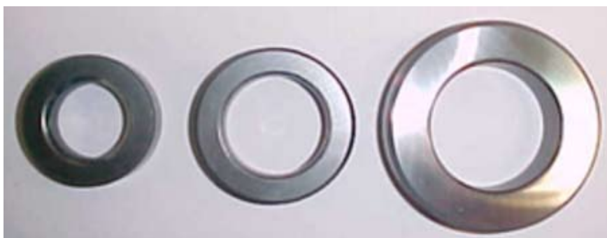
1. Diámetro interno: 24,8mm Área: 483 mm 2 2. Diámetro interno: 32,78mm Área pasaje: 844 mm 2 3. Diámetro interno: 41,10mm Área pasaje: 1326 mm 2
