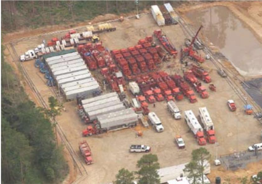
Figura 8. Disposición (*layout*) general de equipos en una *shale frac*
