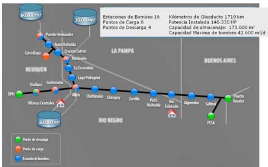
Figura 2. Datos del sistema de oleoductos Oldelval SA, 2010
