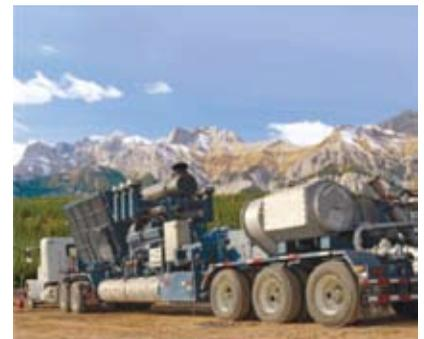
Figura 7. Bomba de alta presión y alto caudal
