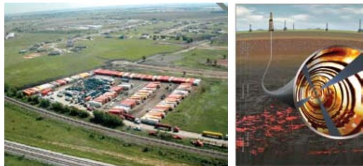
Figura 2. Barnett Shale Gas Fractura en Barnett Shale: para la estimulación de una etapa, se utilizaron más de 100 tanques de agua
