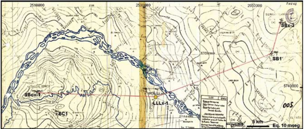
Figura 3. Plano isócrono al tope de la Formación Tordillo de la zona ubicada entre Sauzal Bonito y Sierra Blanca, que indica la ubicación del pozo propuesto LLL.x-1
