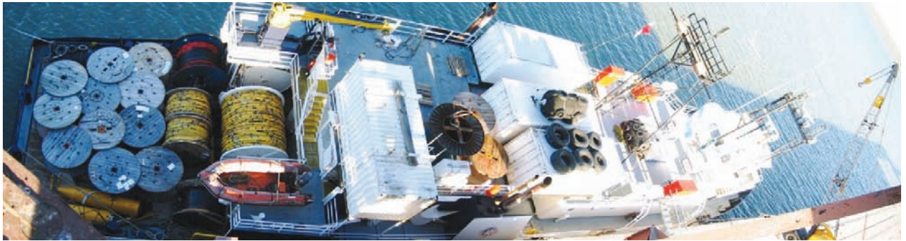
Figura 4. Foto panorámica que muestra un buque de apoyo sísmico antes de su partida a zona de operaciones. El alistamiento de este buque consistió en la carga de cables sísmicos al riel hidráulico, carga de rieles de repuesto para almacenar cables dañados. Provisiones almacenadas en contenedores para carga refrigerada y seca ubicados en la cubierta superior del buque. Equipamiento sísmico, repuestos, combustible y agua.
