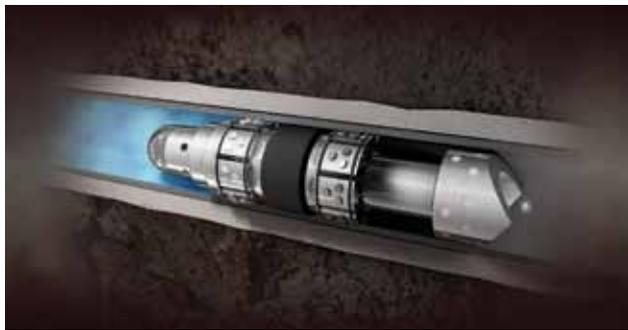
Los tapones solubles se disuelven prácticamente en su totalidad sin dejar restos que obstaculicen la producción o la futura intervención del pozo. Para los tapones con base metálica (generalmente aleación de Mg), la velocidad de disolución depende de la temperatura y la salinidad del fluido a la que se exponen los tapones. En el caso de los tapones base plástica (PGA, ácido poliglicólico), se disuelven solamente con temperatura.
