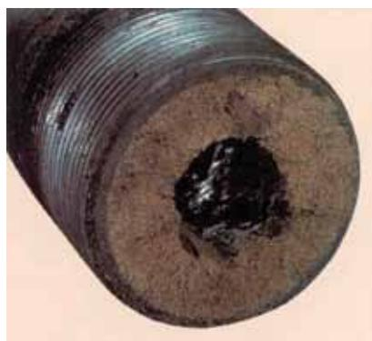
Las parafinas también afectan la reología del crudo al aumentar su viscosidad, incluso al punto de gelificar el petróleo. Dependiendo de la temperatura, el punto de turbidez del petróleo, el contenido de parafina y la tasa de deposición, estas pueden llegar a bloquear completamente el paso del flujo o reducirlo en forma progresiva.
