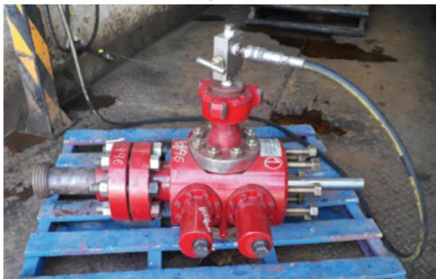
Figura 9. Prueba hidráulica a 10 Mpsi entre los rams.
