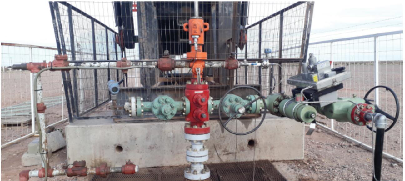
Figura 16. Instalación del conjunto de despresurización en Pzo-5.
