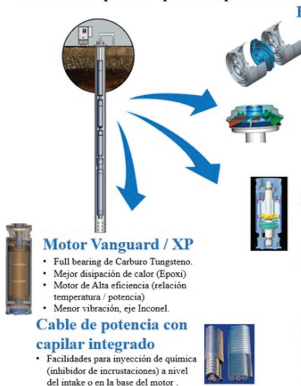
Figura 9. Descripción de componentes del sistema BES para pozos con riesgo de producción de arena. Campo Hokchi.
