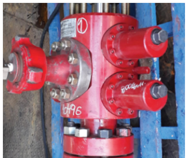
Figura 21. Marca de torque en bulones de bonete de rams.
