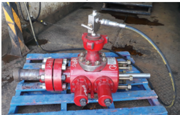
Figura 9. Prueba hidráulica a 10 Mpsi entre los rams.
