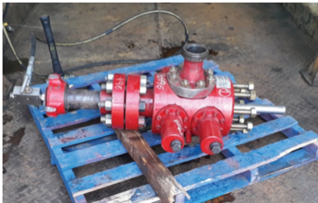
Figura 8. Prueba hidráulica a 10 Mpsi en el sentido de flujo y aplicada sobre el área transversal del vástago.
