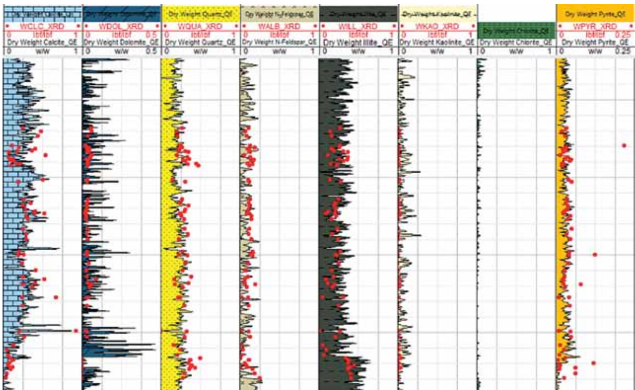
Figura 9. Pozo 1. Comparación de resultados mineralógicos ELAN y análisis XRD del núcleo.
