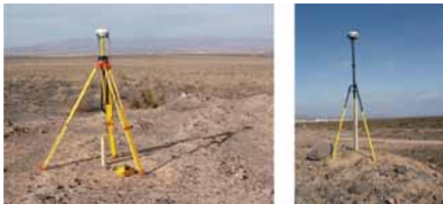
Figura 15. Configuración GPS RTK.
