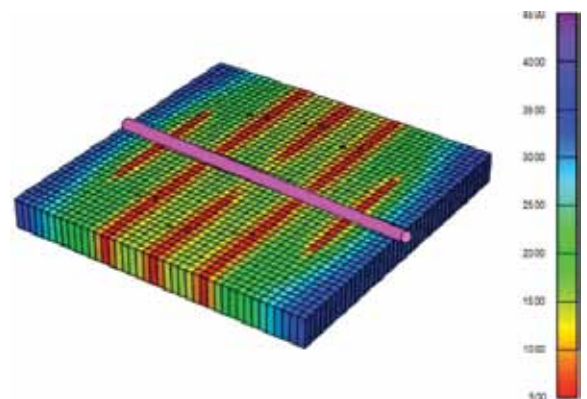
Figura 9. Distribución de la presión después de 30 años con un pozo horizontal con varias fracturas transversales y 15 acres de área de drenaje por fractura.
