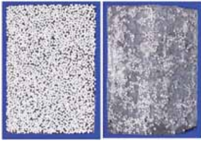
Figura 15. Fractura en una shale arcillosa (lutita) con y sin agente de sostén.
