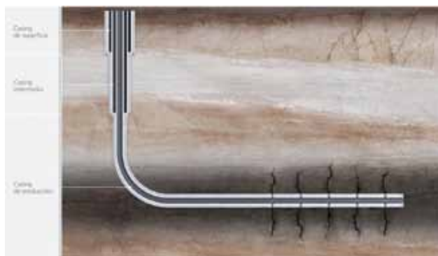
Figura 1. Esquema de pozo típico con tres secciones de tubería.
