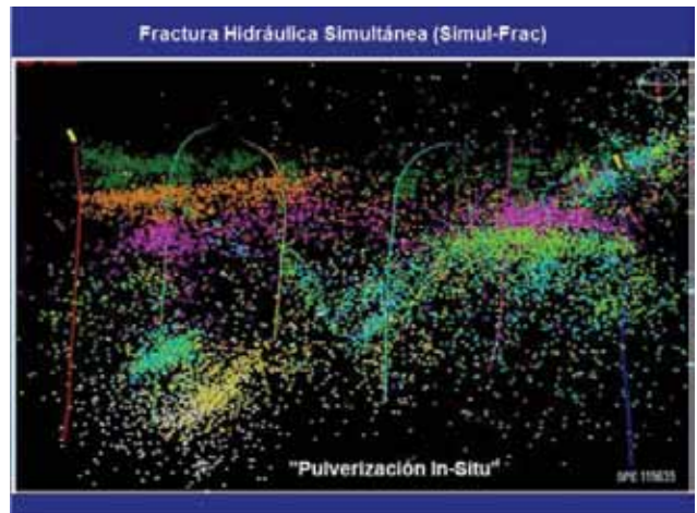
Figura 13. Registro microsísmico de un Simul-Frac .
