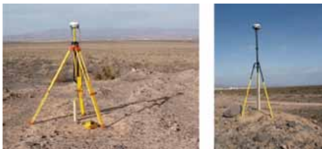
Figura 15. Configuración GPS RTK.
