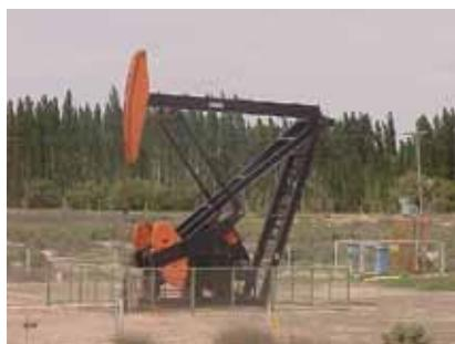
Figura 3. Bombeo mecánico pozo del yacimiento.
