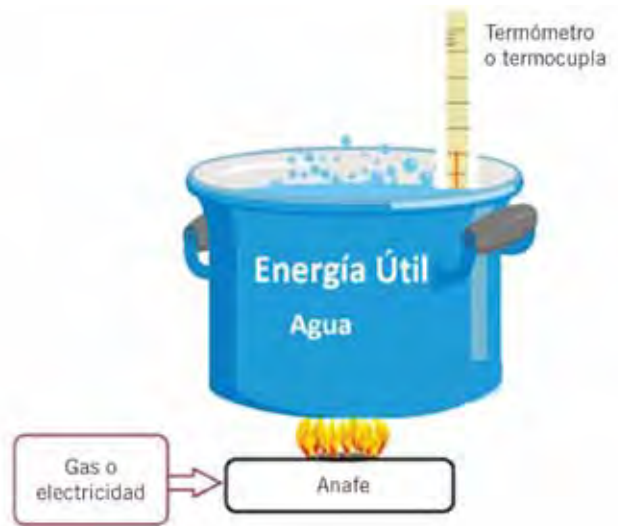
Figura 3. Energía útil y consumida por la olla. Esquema de arreglo experimental para medir la eficiencia. Se mide la masa de agua en la olla y su temperatura inicial y final. Al mismo tiempo, se miden los consumo de gas o electricidad usados para generar este aumento de temperatura.
