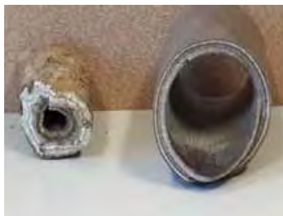
Figura 1. Muestras de incrustaciones formadas en pozos del yacimiento.
