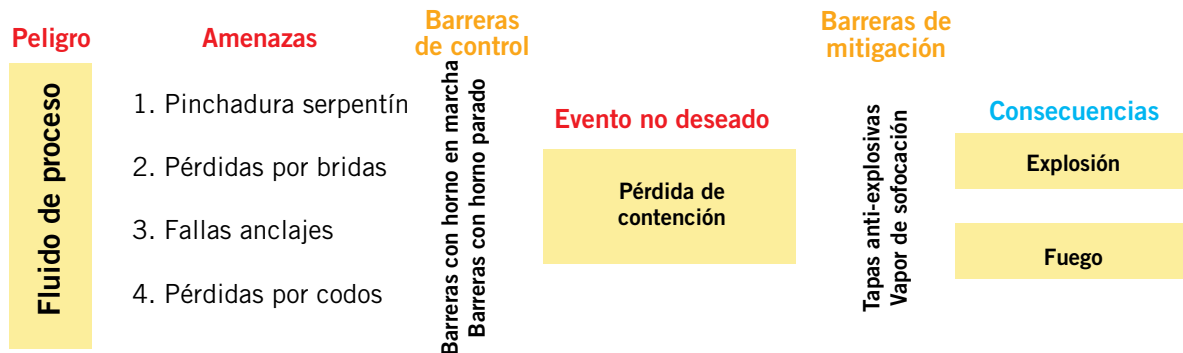
Figura 6. Diagrama de moñó para el evento no deseado de pérdida de contención de fluido de proceso.
