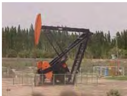
Figura 3. Bombeo mecánico pozo del yacimiento.
