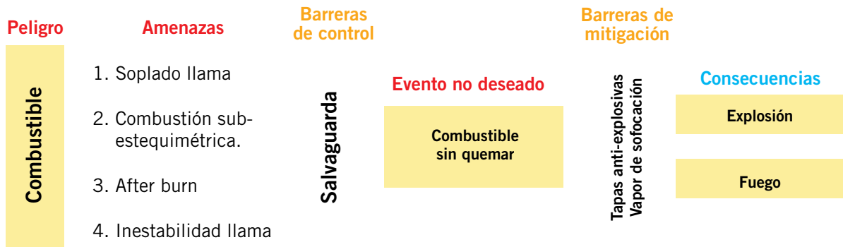
Figura 2. Diagrama de moño para la presencia de combustible sin quemar en el hogar.
