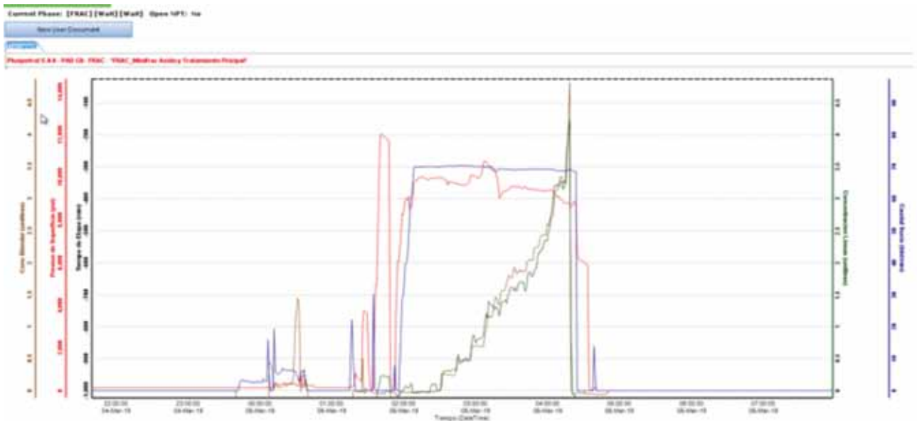
Figura 2. Carta típica de una etapa de fractura. Se destacan los valores que deben adoptar los datos para cumplir con sentencia de detección de fractura, Frac On.
