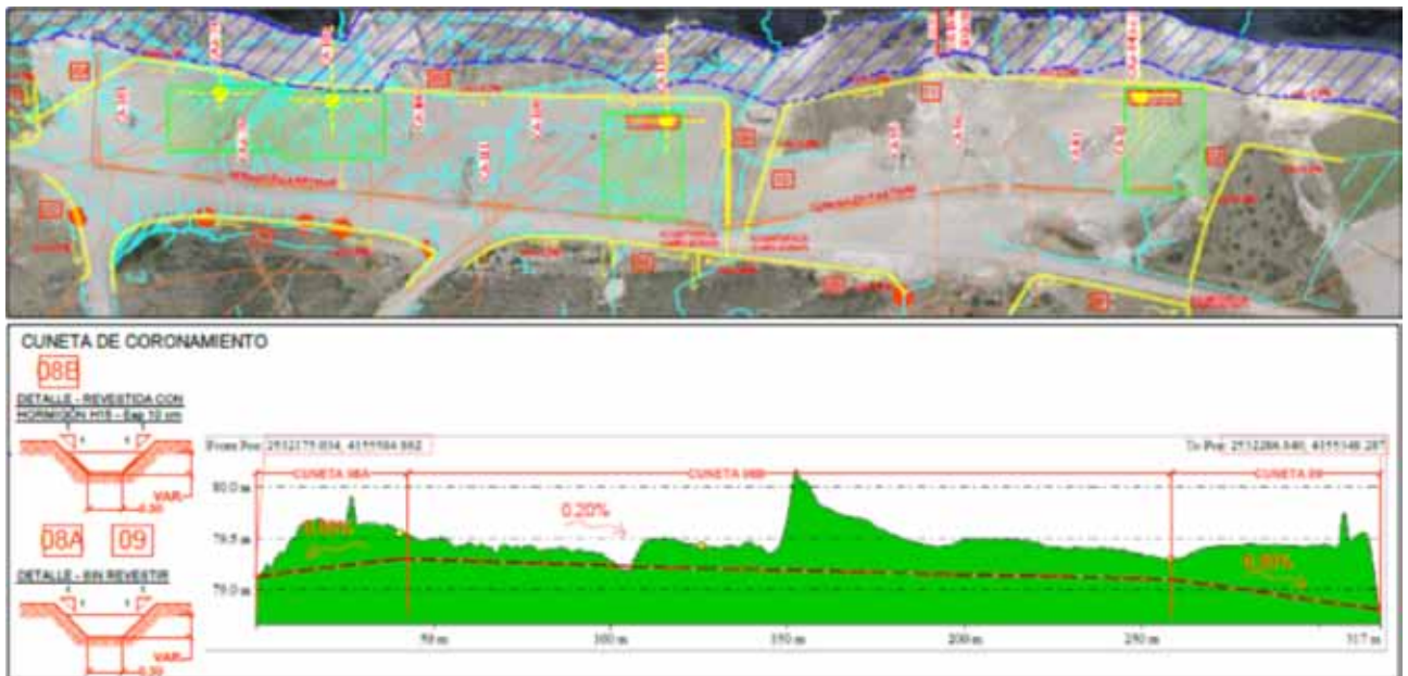
Figura 6. Arriba: ejemplo de diseño red de drenaje con CAD; abajo: ejemplo de corte de cuneta obtenida por GIS.
