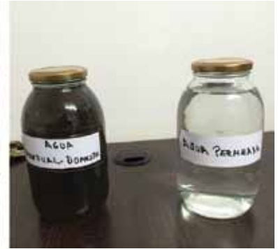
Figura 13. Aguas residuales domésticas e industriales previo y postratamiento a través del sistema de ósmosis inversa.
