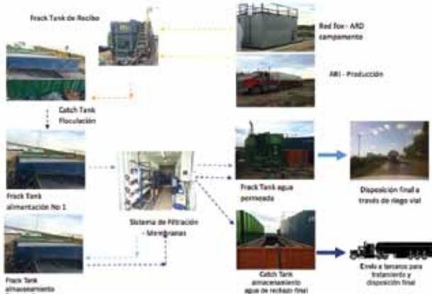
Figura 9. Diagrama de flujo proceso ósmosis inversa.
