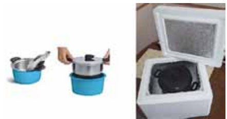
Figura 5. Izquierda: Olla Hot Pan, suiza. Olla metálica que encaja en otra de melamina. Aislante: Aire. Derecha: Olla bruja casera construida con una caja de poliestireno expandido (EPS) o telgopor de 5 cm de espesor, que se usa para transportar alimentos refrigerados. En el interior tiene una capa de aislación térmica de techos. Hay muchos modos de fabricar artesanalmente una olla bruja. 14, 15
