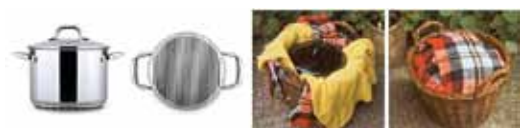
Figura 10. Izquierda: ollas con ranuras, derecha: olla con ranura inmensa en una envolvente aislada. Un modelo comercial de olla con aletas o estrías. Estas estrías hacen más eficientes la transmisión del calor de la llama a la olla. Son especialmente adecuadas para cocinar con gas o leña. Las mejoras en la transmisión de calor pueden ser del orden del 50%. 26 Si esta olla se combina con una envolvente térmica u olla bruja como la imagen de la derecha, los ahorros de energía se suman.
