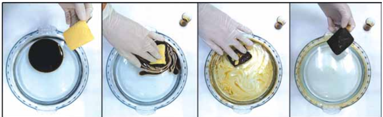
Figura 7. Ensayo de absorción selectiva. Video completo: https://youtu.be/ve4MuZt6UTM en el canal LP&MC de YouTube.
