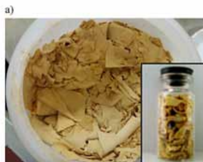
Figura 1. a) Depósito de nanopartículas hidrofóbicas extraídas del reactor en forma de escamas; b) Micrografía SEM de las nanopartículas.
