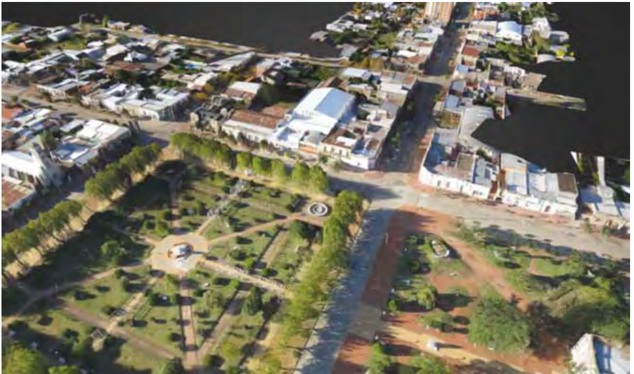
Figura 10. Modelo 3D de la zona central de un pueblo rural del interior de la provincia de Buenos Aires. Resolución de 3cm/pix, tiempo de relevamiento 22 minutos y procesado en 6 horas. Imagen de DroneXplora.
