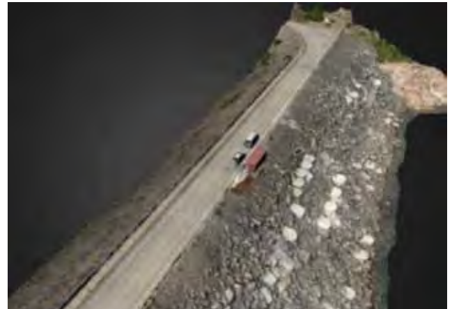
Figura 12. Modelo 3D de la costa occidental de una represa hidroeléctrica de la provincia de Chubut. Resolución de 8 mm/pix, tiempo de relevamiento 19 minutos y procesado en 7 horas. Objetivo: detección de movimiento de rocas por embate de olas. Detección de zonas de erosión y deslizamiento a partir de sucesivos modelos topográficos relevados a lo largo del tiempo. Imagen de DroneXplora.
