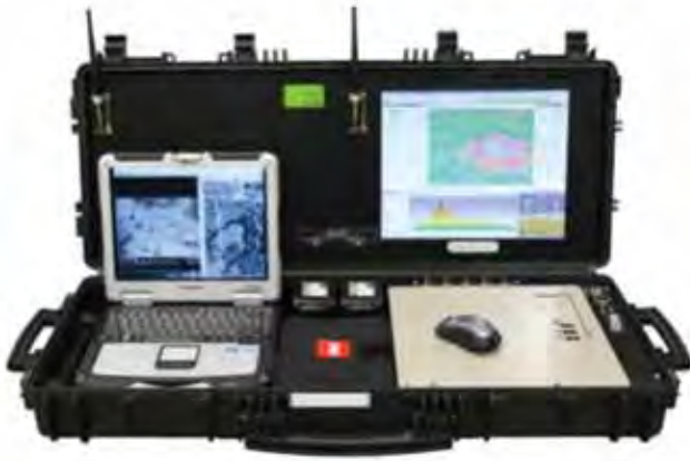
Figura 1. Estación de tierra portátil que utilizamos en el campo. Se recibe video y telemetría en vivo para supervisar la misión y realizar correcciones si es necesario. Equipo utilizado por DroneXplora.
