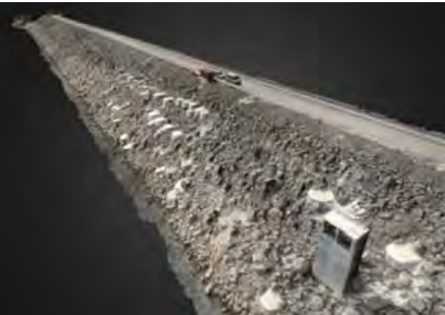
Figura 12. Modelo 3D de la costa occidental de una represa hidroeléctrica de la provincia de Chubut. Resolución de 8 mm/pix, tiempo de relevamiento 19 minutos y procesado en 7 horas. Objetivo: detección de movimiento de rocas por embate de olas. Detección de zonas de erosión y deslizamiento a partir de sucesivos modelos topográficos relevados a lo largo del tiempo. Imagen de DroneXplora.
