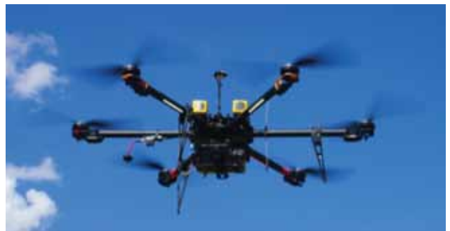
Figura 2. Multirrotor utilizado por DroneXplora para la toma de imágenes y ortomosaicos de muy alta resolución y precisión.
