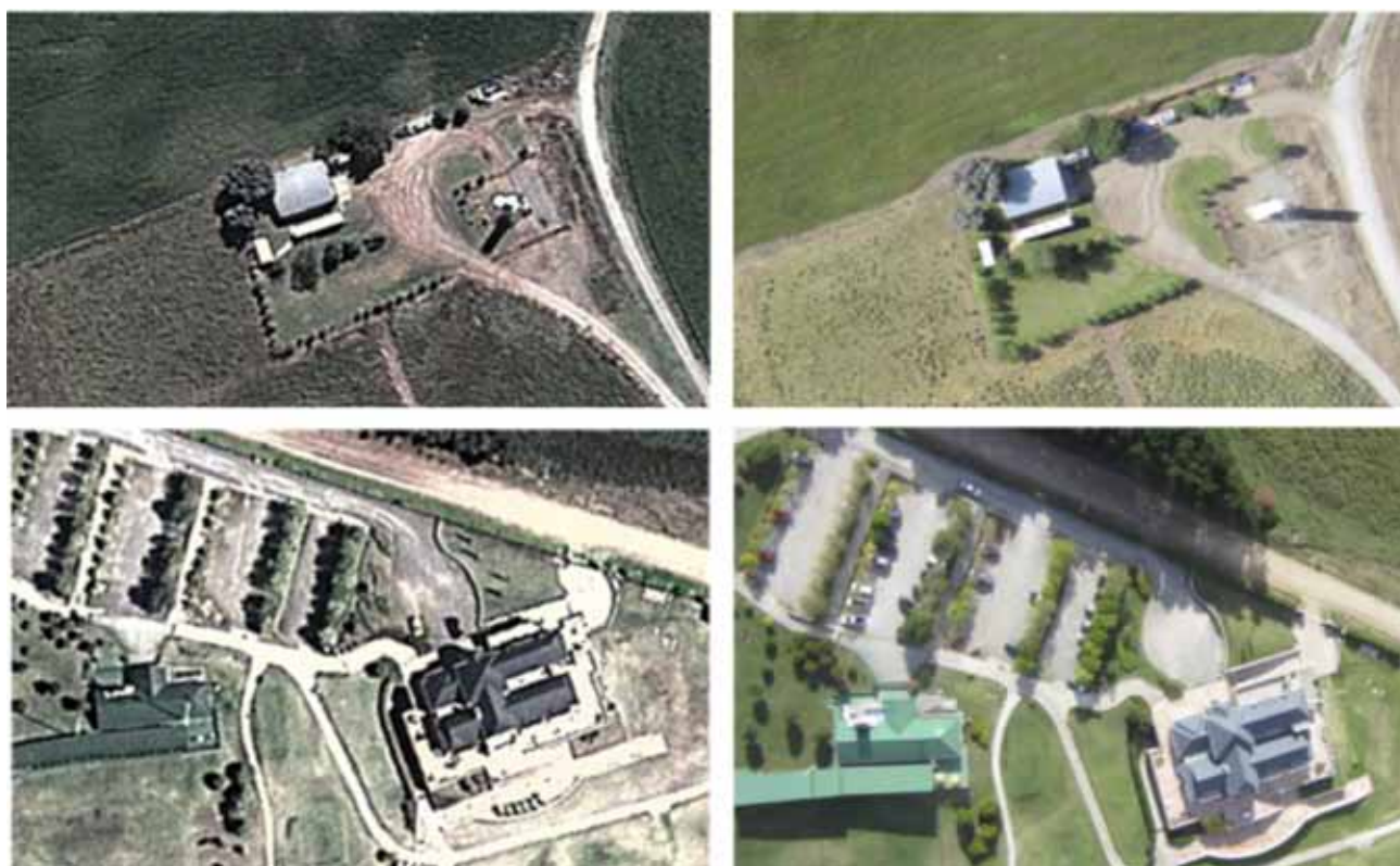
Figura 7. Comparación entre una imagen satelital de 2009 versus un ortomosaico generado por un relevamiento con drones , en este caso por DroneXplora. Izquierda: imagen satelital de 2009. Colores lavados y tinte verde (efecto UV) en toda la imagen. Resolución 50 cm/píxel. Derecha: ortofotomosaico. Marzo de 2014 a 250 m de altura. Colores vivos y reales, mayor nitidez. Resolución 8 cm/píxel.
