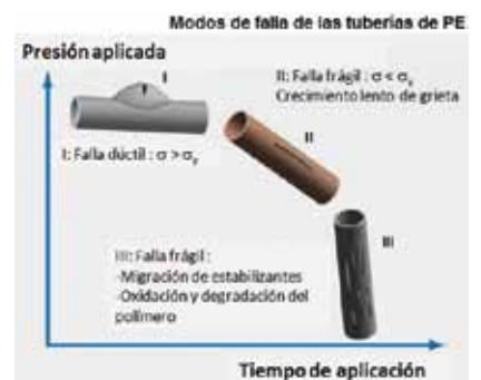
Figura 4. Esquema ilustrativo de la falla de tuberías de PE presurizadas con el tiempo.
