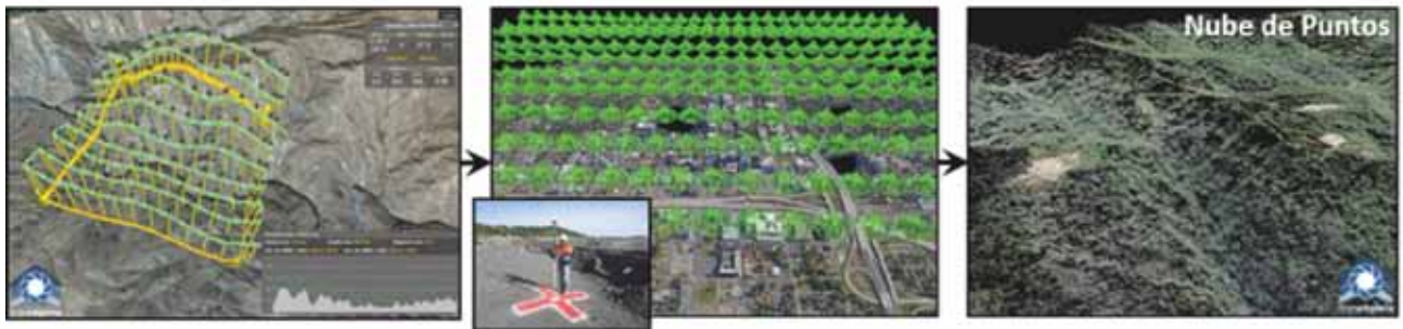
Figura 2. Flujo de trabajo simplificado para un relevamiento fotogramétrico y productos obtenidos: planificación y ejecución del vuelo a Geo-ubicación de fotografías aéreas y procesamiento fotogramétrico a Generación de nube de puntos.
