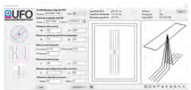
Figura 3. Configuración de un PAD de 8 pozos horizontales de 2.000 m de longitud con un espaciamiento de 125 m y 10 etapas de fractura.
