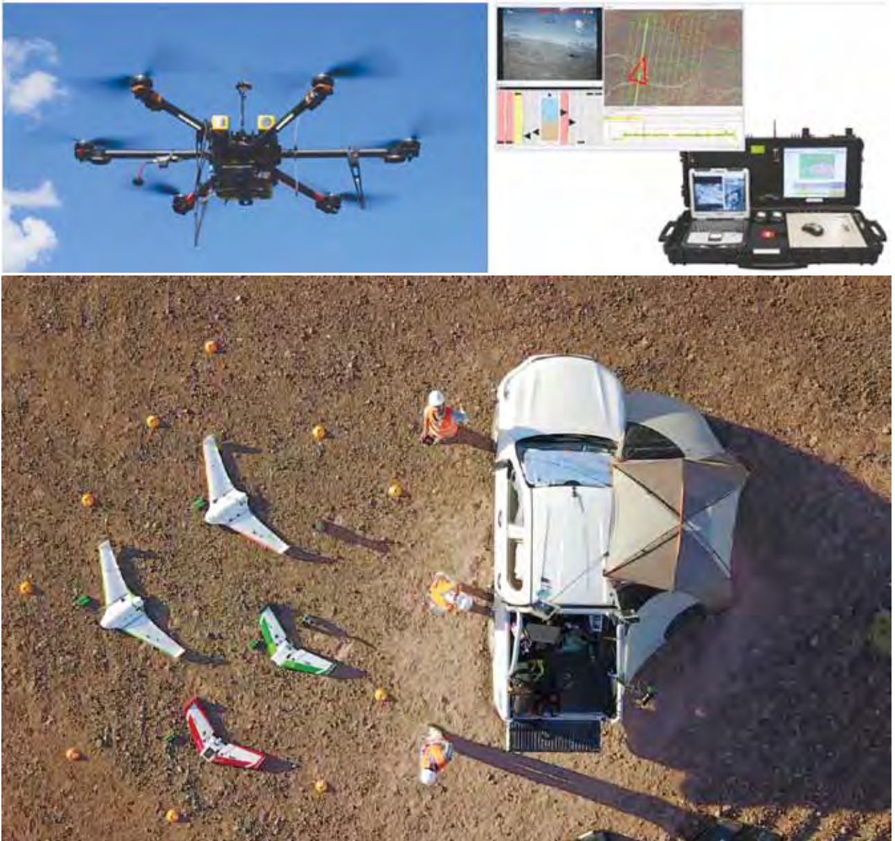
Figura 1. Arriba izquierda: drone tipo ala rotativa o multirrotor. Arriba derecha: estación de tierra para programación y supervisión de plan de vuelo para relevamiento con drones. Abajo: drones del tipo ala fija utilizados para relevamientos de grandes áreas.
