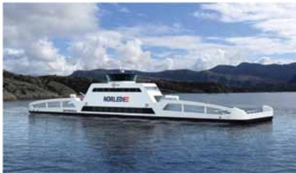
El buque fue diseñado especialmente para adaptarse a los requerimientos de la alimentación a electricidad. El casco fue construido en aluminio en lugar de acero y en lugar de utilizar un motor a diesel, el ferry está equipado con motores eléctricos alimentados con baterías que pesan alrededor de 10 toneladas. Con estas modificaciones, el buque eléctrico pesará solo la mitad que uno convencional.
