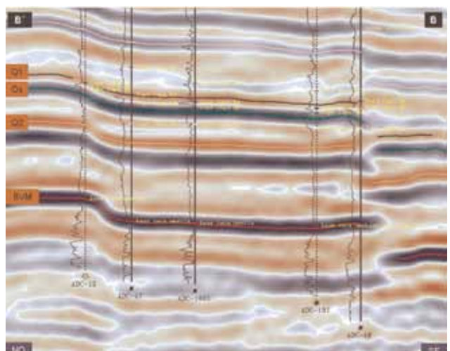
Figura 14. Sección NO-SE, ambos pozos extremos encuentran la capa A afectada por falla.
