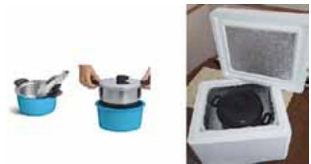
Figura 5. Izquierda: Olla Hot Pan, suiza. Olla metálica que encaja en otra de melamina. Aislante: Aire. Derecha: Olla bruja casera construida con una caja de poliestireno expandido (EPS) o telgopor de 5 cm de espesor, que se usa para transportar alimentos refrigerados. En el interior tiene una capa de aislación térmica de techos. Hay muchos modos de fabricar artesanalmente una olla bruja.<sup>14, 15</sup>
